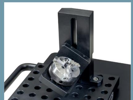
Der Spannmittelständer stellt in Kombination mit standardisierten Spannvorrichtungen die flexible Positionierung Ihres Prüflings sicher.
